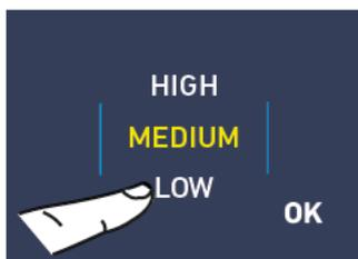
**C)** Deslizar los valores hacia arriba o hacia abajo hasta configurar la humedad deseada.
