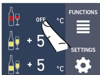
**1)** Pantalla home. Para volver a encender un compartimento apagado, tocar el icono OFF en el costado.
