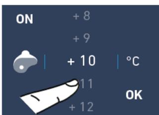
**F)** Desplazar los valores hacia arriba o hacia abajo para seleccionar la temperatura deseada (de +8 °C a +17 °C) y pulsar OK.
