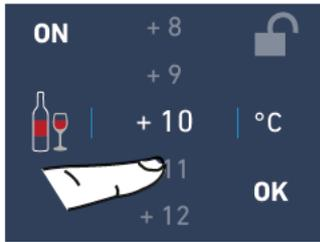
**2)** Desplazar los valores hacia arriba o hacia abajo para seleccionar la temperatura deseada (en caso del compartimento Cantina, la temperatura se puede configurar de +4 °C a +18 °C)
