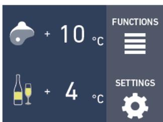
**D)** Sur la page-écran apparaît l'icône **JAMBONNERIE** à la place de celle des vins. Le compartiment maintiendra automatiquement la température à +10 °C et l'humidité moyenne sera réglée.
