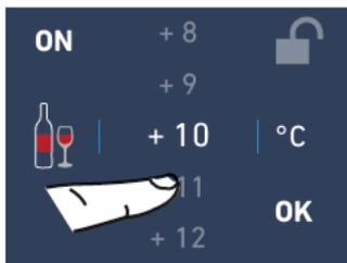
2) Faire défiler les valeurs vers le haut ou vers le bas pour sélectionner la température souhaitée (dans le cas du compartiment Cantina, la température peut être réglée de +4 °C à +18 °C)
