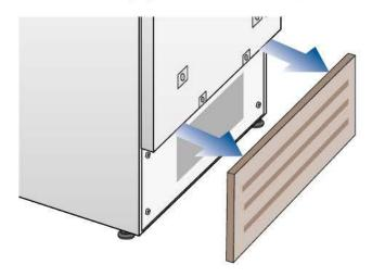
> Pulire il condensatore in modo approfondito da ogni deposito di polvere come illustrato in figura avendo cura di non danneggiarlo.
