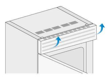
> Pulire il condensatore in modo approfondito da ogni deposito di polvere come illustrato in figura avendo cura di non danneggiarlo.
